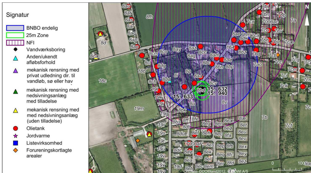
Figur 25-3 Oversigtskort med beliggenhed af potentielle forureningskilder ved Moseby Vandværk
