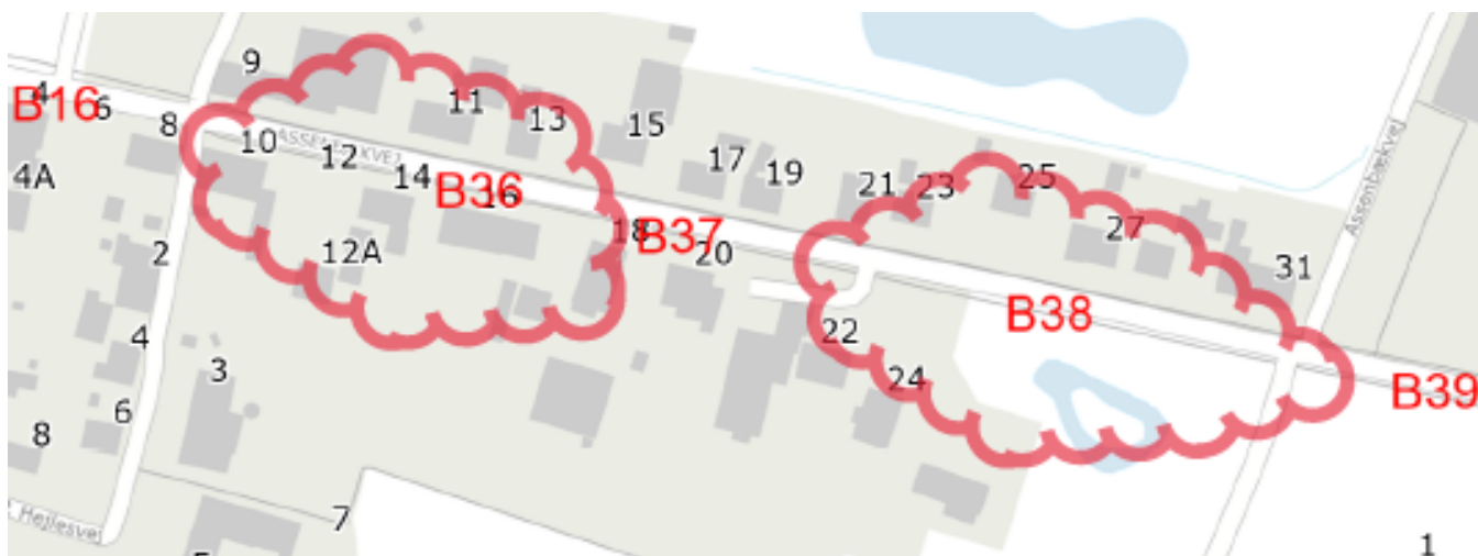
Figur 1 Viser placering af eventuelle filterboringer, der kan opstå behov for.
