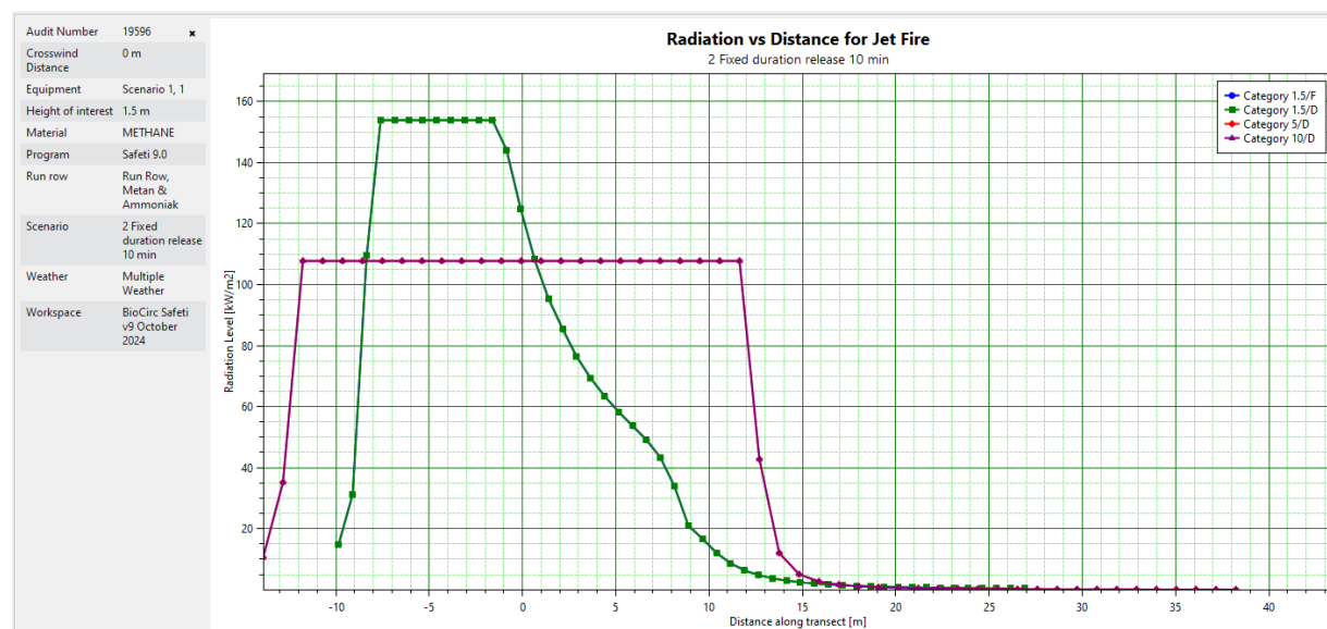
Figur 6 Stråling som funktion af afstand ved jetbrand
