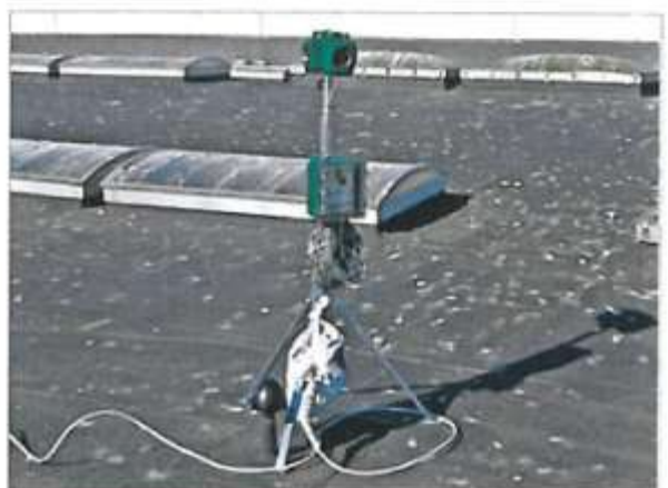
En BirdGard er et akustisk fugleskræmsel. Installationen afspiller på tilfældige tidspunkter lyden af en måge i nød. Ved hjælp af fire kraftige højttalere spredes lyden over et stort areal
